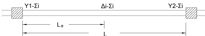
(β) Τοποθέτηση της δοκού που φέρει το φυτευτό υποστύλωμα.
